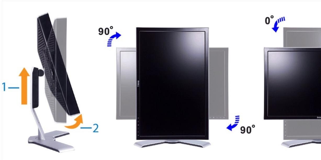
**HINWEIS:** Um die Funktion "Display Rotation" ("Bildschirmdrehung") (Ansicht im Querformat versus Hochformat) nutzen zu können, ist ein aktualisierter Grafikkreiber für Ihren Dell™ Computer erforderlich, der nicht mit diesem Monitor ausgeliefert wird. Bitte laden Sie den Grafikkreiber von [support.dell.com](http://support.dell.com) herunter und beziehen Sie sich auf den Abschnitt "Download" ("Download") für "Video Drivers" ("Videotreiber") für neuere aktualisierte Treiber.
