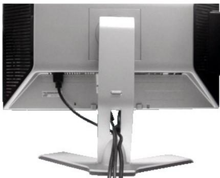
Nachdem Sie alle notwendigen Kabel an Ihren Monitor und Computer angeschlossen haben (siehe [Einrichten Ihres Monitors](#) für Informationen über das Anschließen von Kabeln), verwenden Sie die Auslassung für die Kabelverlegung, um alle Kabel wie oben gezeigt zu verstauen.
