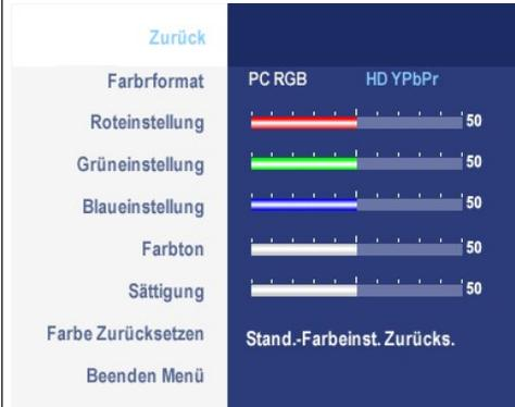
Zum Erzielen des unterschiedlichen Farbspektrums für PC RGB und HD YPbPr (HD YPbPr eignet sich für HD- und PC-Grafik-Anzeige über DVI.).
